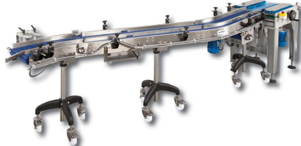
SINCRONIZZATORE AUTOMATICO: costruito interamente in acciaio inox, permette di sincronizzare i prodotti con l'alimentazione della macchina evitando le buste vuote. E' correddato di apposite cinghie laterali per trattenere i prodotti delicati e di nastro centrale estraibile per la sanificazione. E' adatto per tutti i tipi di prodotti da forno, pasticceria in genere e prodotti in vassoio. Dimensioni: lunghezza min:100mm, max :300mm larghezza min: 75mm, max:200mm.
